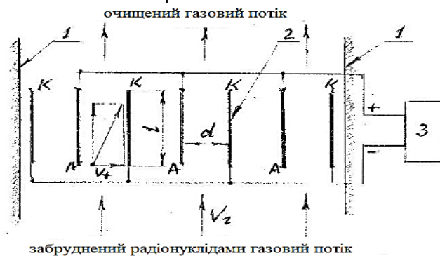
Рисунок 1 Схема електрофільтру для очищення газоаерозольних викидів, забруднених радіонуклідами
