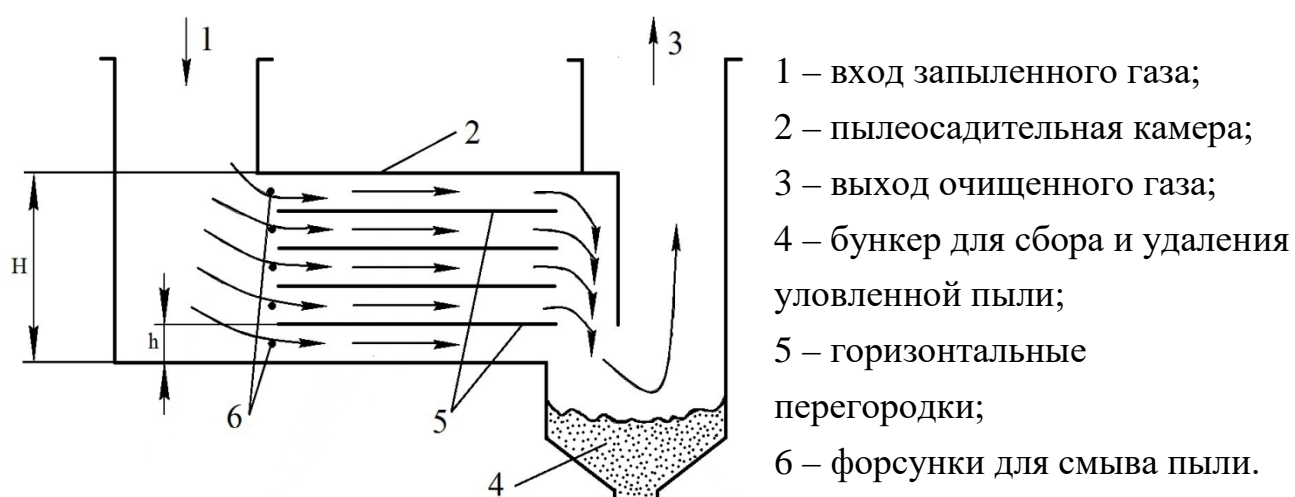
Рисунок 2.2 – Пылесадительная камера с горизонтальными полками
