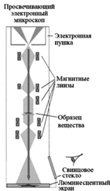
Рис. 1.2. Принципиальная схема ПЭМ
