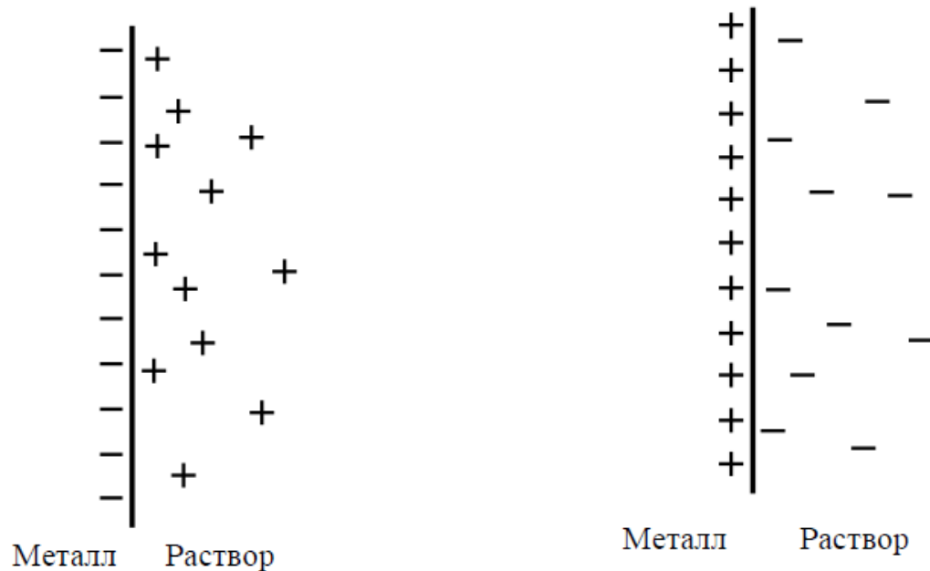
Рис.1.2. Подвійний електричний шар на межі метал - розчин а - активний метал ( E_{кр} < E_{гидр} ); б - малоактивний метал ( E_{кр} > E_{гидр} )
