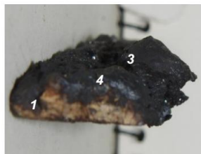
Рис. 5. Картина плавлення (а) та розтікання краплі модифікованого шлаку (б) з утворенням гарнісажного шару на вогнетриві: 1 – вогнетрив; 3 – крапля шлаку; 4 – гарнісажний шар
