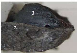
Рис. 5. Картина плавлення (а) та розтікання краплі модифікованого шлаку (б) з утворенням гарнісажного шару на вогнетриві: 1 – вогнетрив; 3 – крапля шлаку; 4 – гарнісажний шар
