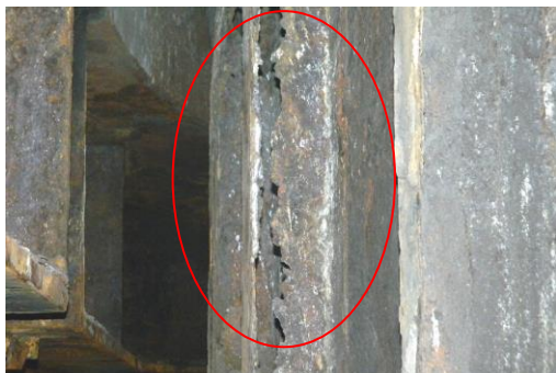
Рисунок 1 – Результат корозійного зносу опори поворотного стенда МБЛЗ
