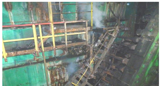
Рисунок 2 – Результат корозійного зносу броні струмків МБЛЗ
