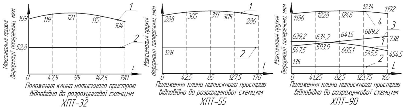
Рис. 2. Пружні деформації поперечин станин з урахуванням положення клинів натискних пристроїв робочих клітей: 1 – верхня поперечина станини прямокутної конструкції; 2 – верхня поперечина станини раціональної конструкції; 3 – нижня поперечина станини прямокутної конструкції; 4 – сумарна деформація поперечин станини прямокутної конструкції
