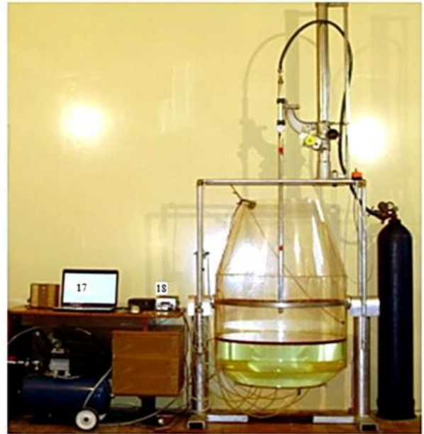
Рис. 1. Схема лабораторної установки: 1 – посудина (органічне скло), 2 – опора фурми, 3 – цапфи, 4 – манометр, 5 – колектор, 6 – магістраль, 7 – опора установки, 8 – донні продувальні елементи, 9 – опорне кільце, 10 – компресор, 11 – балон, 12 – кран, 13 – напрямна фурми, 14 – лінійка, 15 – фурма, 16 – стійка, 17 – програмне забезпечення, 18 – АЦП.
