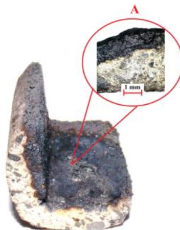
Рис. 5. Підготовлена вогнетривка підкладка, що імітує футерівку агрегату (30×30×30 мм); А – глибина інфільтрації шлаку у вогнетрив.
