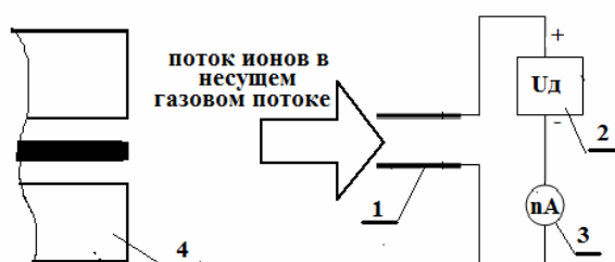
Рисунок 2 – Измерительная схема оценки степени активизации газа с применением зонда Ленгмюра
