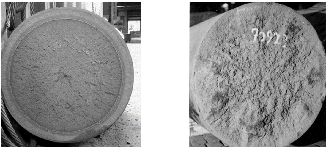
Рисунок 2.2 – Руйнування валків внаслідок термічних напружень
