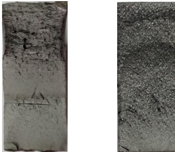
Рисунок 3.10 – Злами гладких зразків сталей 09Г2С (ліворуч) і Х12Ф1 (праворуч), що отримані при три точковому циклічному згині.
