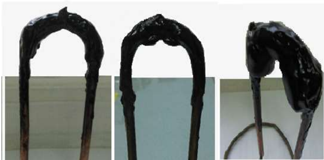
Рисунок 3.2 – Утворення відкладів АСПВ на холодному стрижні через а) 10; б) 20; в) 30 хв роботи установки
