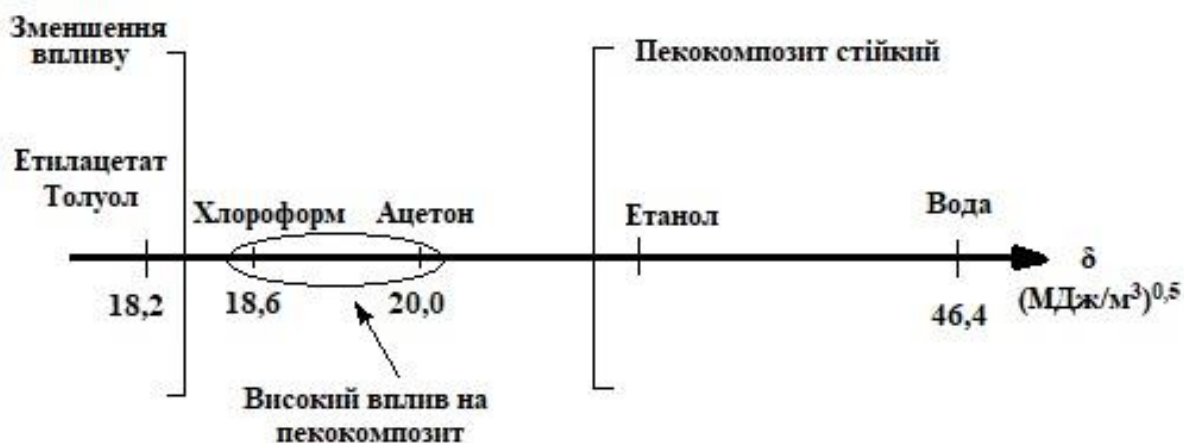
Рисунок 5.21 Умовна схема впливу показника розчинності агресивних середовищ на стійкість пекокомпозиту
