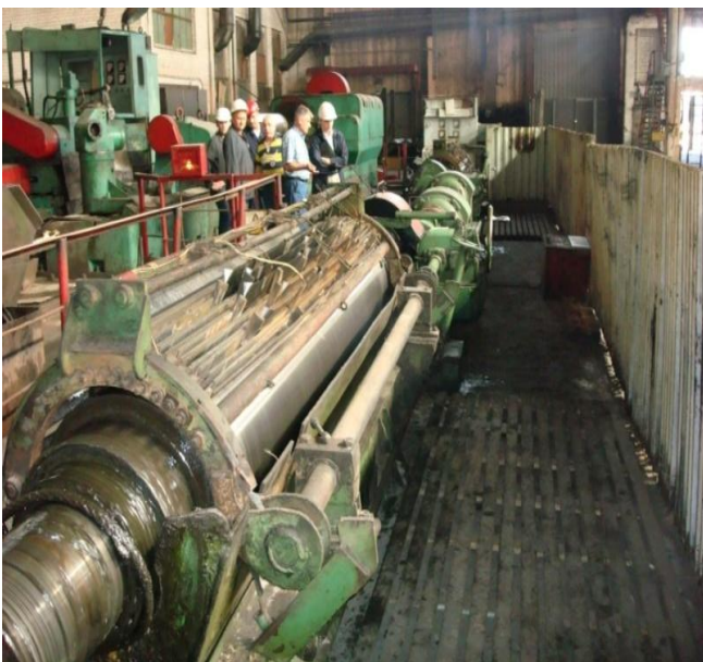
Установка для текстурування валків листопркатних станів на заводі «Запоріжсталь». Працює з 1973 р. до теперішнього часу.
