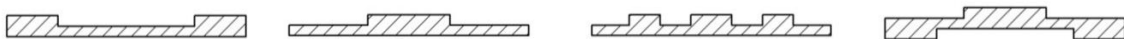
Рисунок 4 - Деякі види поперечного перерізу профільованих штаб, що можна реалізувати за допомогою розробленого пристрою валкової розливки-прокатки
