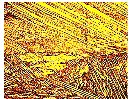
а, б – x400 Рисунок 4 – Мікроструктури алюмінієвої бронзи із вмістом алюмінію 12мас.% в рівноважному (а) та загартованому стані (б)
