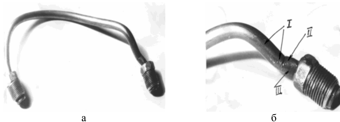
Фототаблица I. Общий вид тормозной трубки /а/ и места ее разрушения /б/ обозначения: 1– следы пластической деформации; 2– место максимальной пластической деформации; 3 – следы механического повреждения трубки о внутреннюю поверхность крепежного шнура
