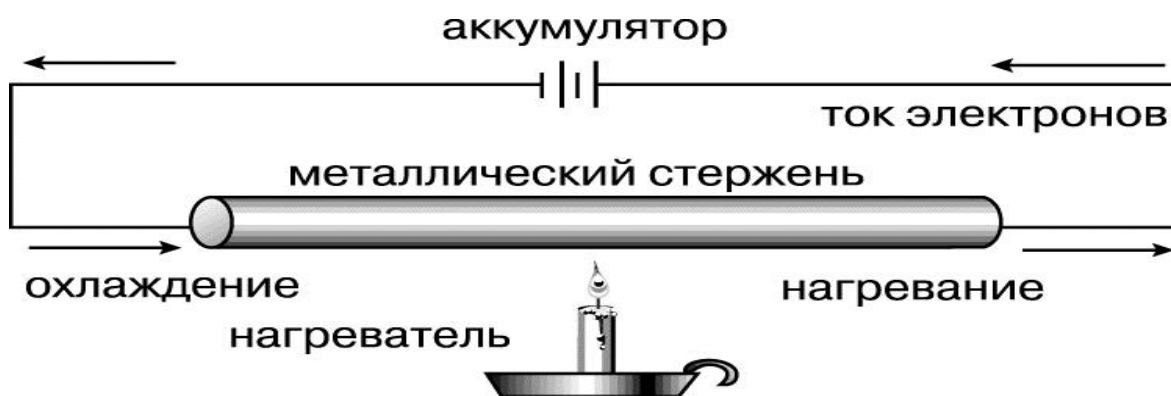
Рис.1.3. Электротермический эффект Томсона. При пропускании тока через проводник, нагреваемый в средней точке, один его конец немного нагревается, а другой слегка охлаждается. Какой именно нагревается, а какой охлаждается - это зависит от направления тока в цепи.
