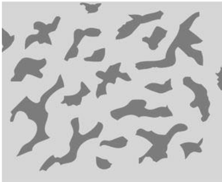
Рис. 23. Схематическое изображение промежуточного состояния сверхпроводящей пластины, ориентированной перпендикулярно магнитному полю
