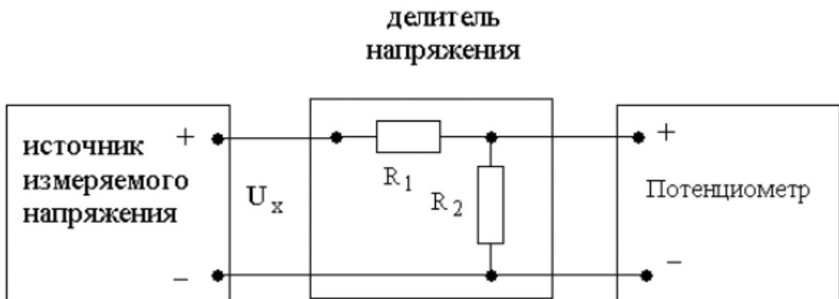
Рисунок 11.2 Схема подключения потенциометра для расширения пределов измерения
