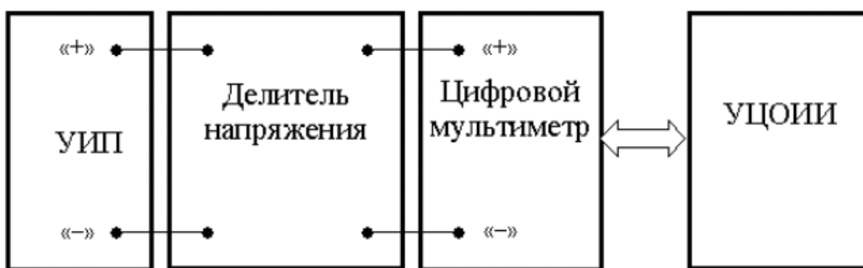
Рисунок 3.2 Схема соединения приборов при выполнении работы
