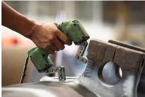
Рисунок 2 – Магнітнопорошковий метод вимірювання
