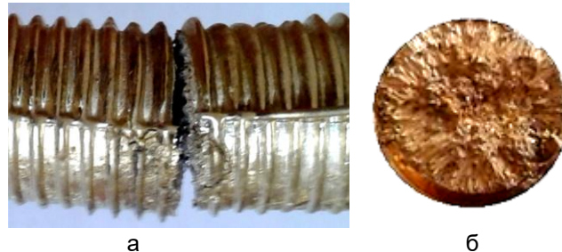
Рисунок 3 – Зовнішній вигляд гарячої тріщини (а) та макроскопічна презентація поверхні руйнування по гарячій тріщині (б) в зразку
