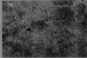
Рис. 2. Микроструктура эвтектоидной стали.
